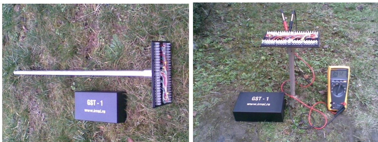
Слика 26. Термисторски низ за мерење температурног профила тла (GST-1): а- прототип у хоризонталном положају (лево) и б- прототип у вертикалном положају постављен на мерно место (десно).
