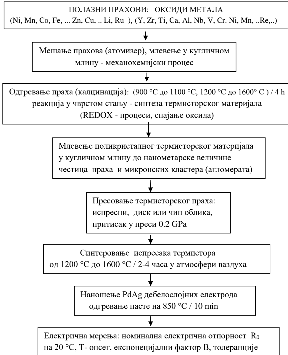
Слика 3. Дијаграм тока процеса за добијање NTC термистора.
