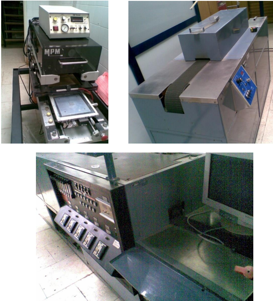
Слика 18. Опрема за дебелослојну технологију штампач за дебеле слојеве (горе лево), сушница за дебеле слојеве (горе десно) и петозонска конвејерска пећ за синтеровање (Ирител, а.д. Београд).
